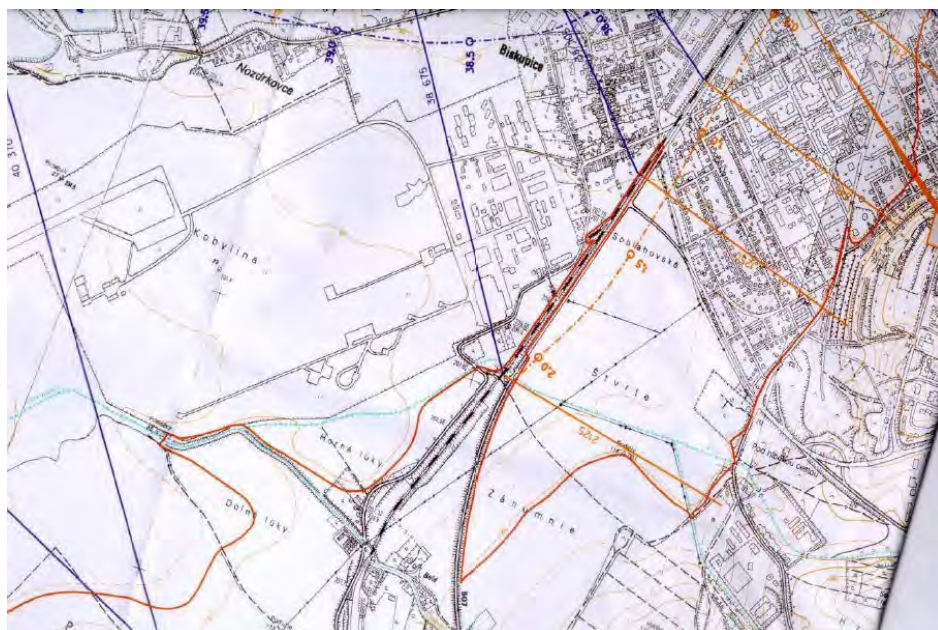
Obr. B.10-3-4,5 Dosah záplavovej vlny na južnú časť mesta
